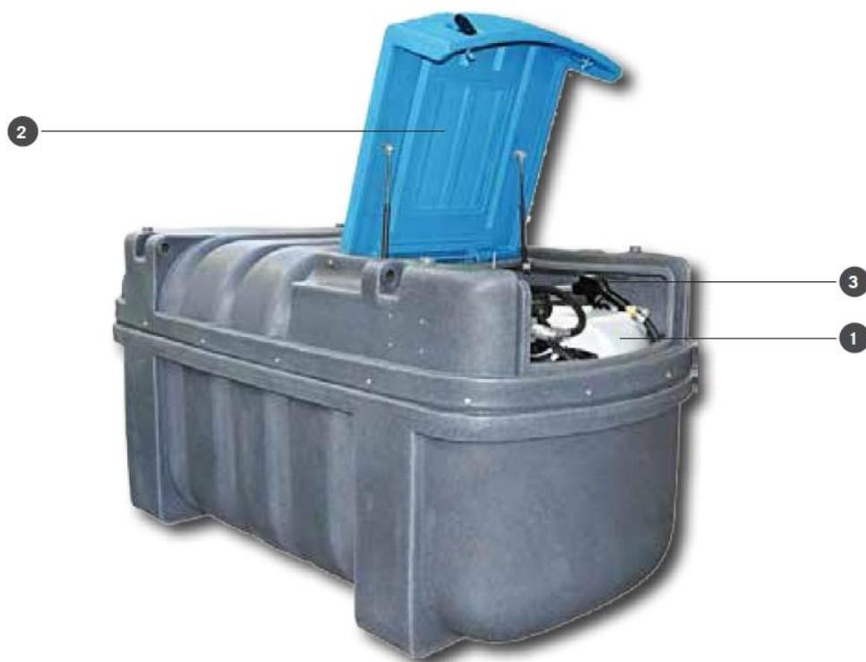
**"La cuve PolyBlue est la solution pratique et résistante pour le stockage et la distribution de l'AdBlue®. Son logement pompe, sécurisé et accessible, permet d'effectuer les opérations de remplissage depuis le sol. Construite en polyéthylène, elle est résistante à la corrosion et stabilisée contre les rayons UV. Sa double paroi prévient les risques de pollution de notre environnement."**
