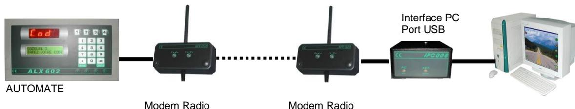
Le logiciel ALX communique avec un ou des automates via une interface PC et des modems radios.
