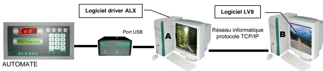
Pour les ordinateurs utilisés en INTERFACE RESEAU (cas du poste **A** ci-dessus), il convient d'installer un logiciel driver (**DRIVER.EXE**). Une fois installé, il se présente sous la forme d'un icône en bas à droite du bureau, sur lequel il faut faire un double clic pour ouvrir la fenêtre de visualisation des quantités d'informations en transit.
